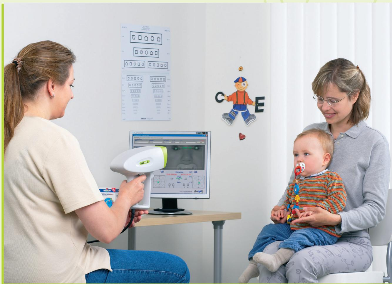
Mit moderner Messtechnik von Plusoptix dauert die Refraktionsmessung nur wenige Sekunden.
